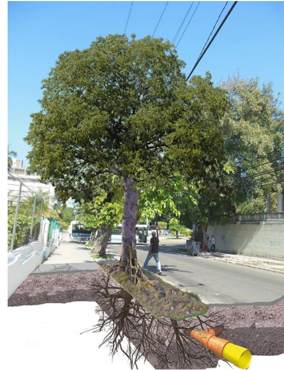
Figura 2: Esquema de interacción de ejemplar de arbolado viario con elementos circundantes: redes aéreas y soterradas, pavimentos, cierres, edificaciones y población. Fuente: elaborado por los autores.
