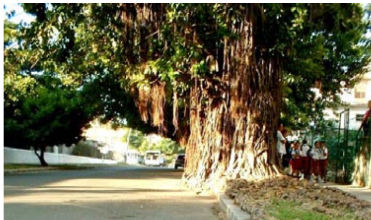
Figura 11: Calle con ejemplares de Ficus sembrados en su sección, obsérvese conflictos con los pavimentos y el uso del espacio. Fuente: tomada por los autores.
